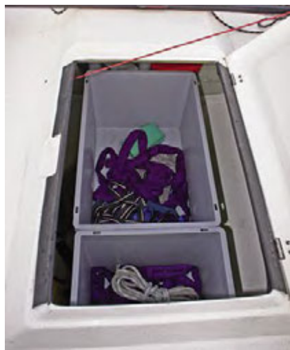
Unter der vorderen Klappe in der Plicht befinden sich zwei Staukästen. Gut zu sehen sind die Hebegurten.
