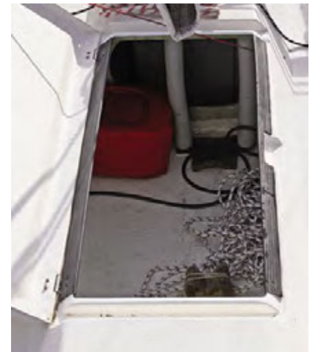
Im hinteren Staufach unter dem Cockpit kann ein kleiner Aussenborder mitsamt seiner Halterung untergebracht werden. Spezielle Befestigungen liefert die Werft.
